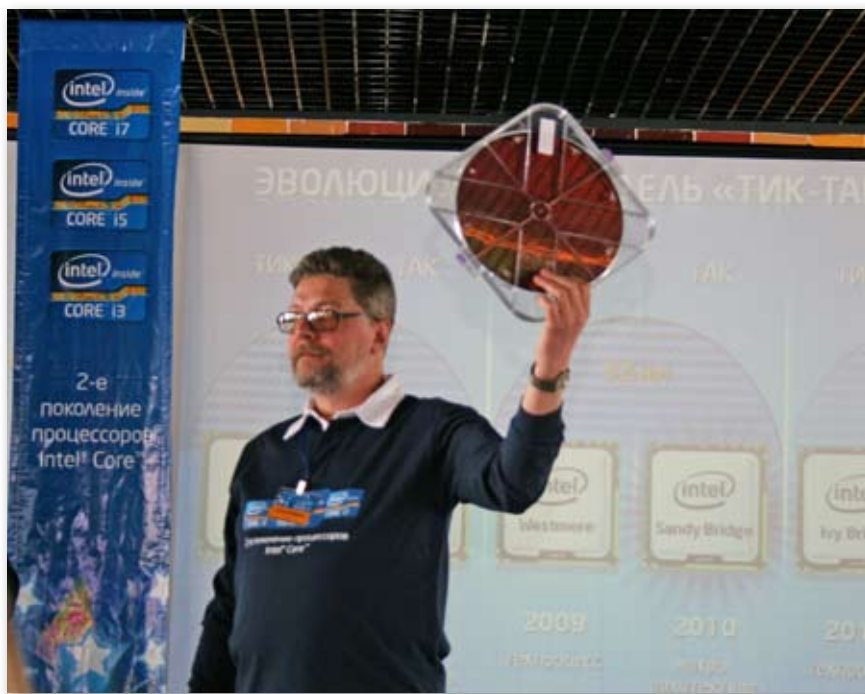
Пластина диагональю 300 мм в руках Михаила Рыбакова содержит 400 процессоров 2-го поколения Intel Core. При средней стоимости процессора в 150 долларов ее цена составляет 60000 долларов.
