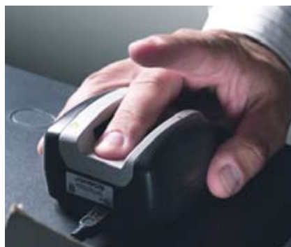
Приобретаемый дополнительно аутентификатор пользователя по рисунку капиллярной сетки обезопасит аппарат от несанкционированного доступа
