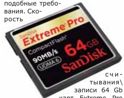
считывания/записи 64 Gb карт Extreme Pro составляет 90 Mb/c, а разброс допустимых температур для работы - от -25° до +80° при 90% влажности.
