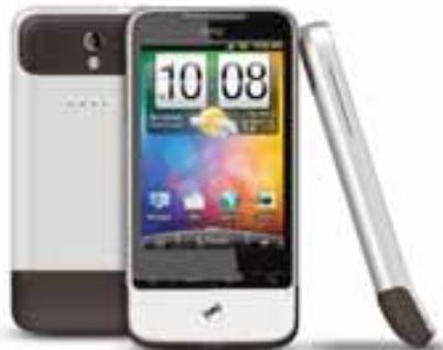
дартным корпусом с нижней частью, расположенной под небольшим углом. 11-миллиметровый корпус выполнен из алюминия, но общий вес модели даже с учетом аккумулятора на 1800 мАч не такой уж и большой - всего 136 граммов. Лицевая часть аппарата HTC Legend почти вся отдана под AMOLED-экран с диагональю 3,2 дюйма и поддержкой multi-touch. Прямо под ним находятся четыре софт-клавиши, а еще ниже так называемый оптический джойстик. HTC Legend поступит в продажу на терри-
