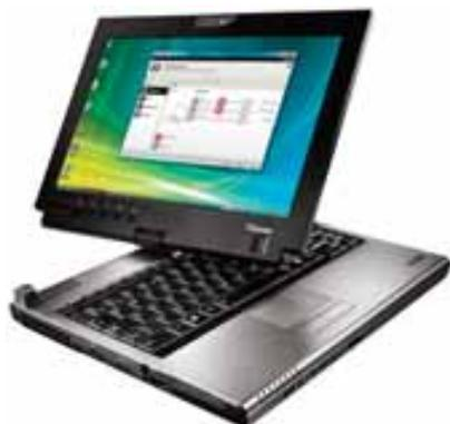
разрешением 1200x800 пикселей и технологией подсветки TruBright LED. Благодаря форм-фактору трансформируемого планшета устройство получило сенсорный дисплей с поддержкой мультисенсорного ввода и технологии распознавания жестов в Windows 7. Характеристики M780 следующие: процессор Intel Core i3 или Core i5; 8 Gb оперативной памяти; 2,5" HDD или SSD; 2x USB; Bluetooth 2.1; Wi-Fi; web-камера и сканер отпечатков пальцев.
