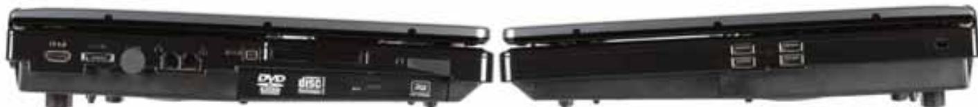
тели расположены четыре аудио-разъема: line-in (линейный вход), headphone-out (выход для наушников), microphone-in (микрофонный вход) и S/PDIF-out (цифровой выход). Что интересно, эти разъемы с помощью драйверов могут конфигурироваться для подключения к ним аудиосистемы 5.1. На левой боковой панели расположены следующие разъемы: HDMI (через который можно подключить ноутбук к источнику изображения для просмотра видео высокой четкости), e-SATA (для подключения внешних носите-
