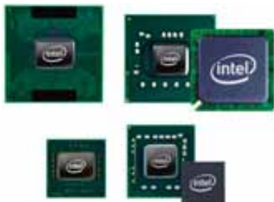
Отличие процессора Intel Core 2 Duo с чипсетом GM40 Express (сверху) от платформы CULV
