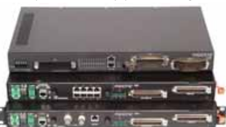
Оборудование DSLAM для АТС
