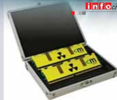
льность устройства. Характеристики памяти Mushkin 996599r следующие: объем 4096 Mb, тип памяти DDR2 (две "планки" объемом 2 Gb каждая), значения задержек 5-5-5-15, рабочая частота 1066 MHz; рабочее напряжение 2,1 Вольт.
