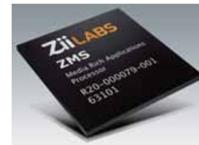
станет ZMS-05. Чип ZMS-05 объединяет в себе 24 шейдерных процессора обработки мультимедиа, два вычислительных ядра 926EJ-S архитектуры ARM, а также множество интегрированных контроллеров для подключения периферии. Creative сообщила, что компании MSI, F&S Electronic, MediaNet, PowerLinux, Perception digital и Grandeye уже высказали желание использовать Zii в своих продуктах.
