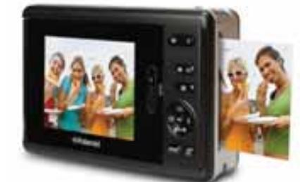
2009 этот производитель представил камеру Polaroid PoGo Instant Digital Camera со встроенным принтером. Инженеры Polaroid использовали выпущенный ранее мобильный принтер PoGo, добавив к нему миниатюрный модуль камеры. Устройство прекрасно помещается в карман пиджака. Хоть принтер и выдает весьма специфичные отпечатки, не слишком точно передавая
