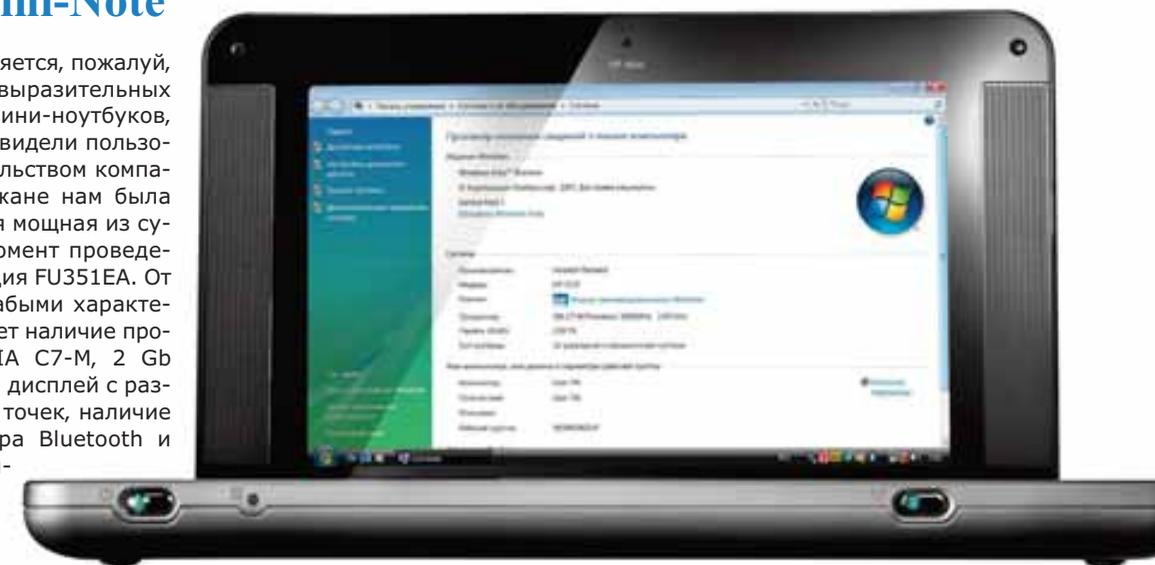
Как и положено ультрапортативному решению, размеры и вес устройства невелики, что позволяет с легкостью носить нетбук даже в небольшой сумке. Масса блока питания составляет 280 граммов и еще столько же весит кабель. Таким образом, общий вес не превышает 2 кг, что на 1-1,5 кг легче обычного 14-дюймового ноутбука.
