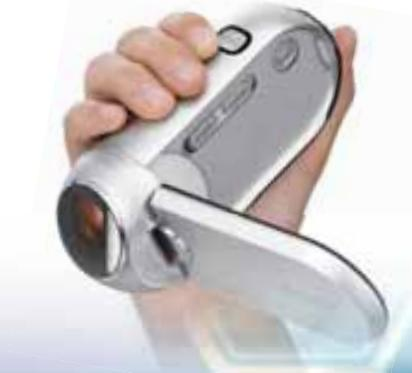
HMX-R10 оснащена 2,7-дюймовым сенсорным экраном, слотом для карточек SD/SDHC, компонентным, композитным и HDMI разъемами. Формфактор камеры располагает к комфортной съемке. Объектив наклонен на 25 градусов, что позволяет удобно держать в руке камкордер, так как при таком положении значительно снижается напряжение запястья. В продаже новинка появится в марте.
