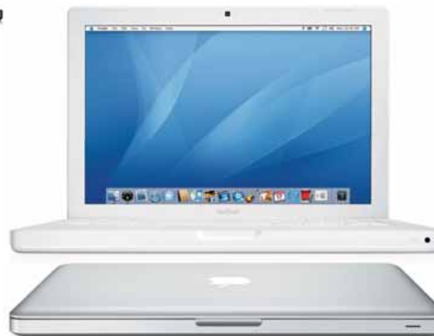
На смену пластиковым корпусам старых MacBook пришел Unibody, корпус, изготовленный из цельного куска алюминия
