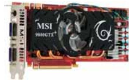
разгоном. Характеристики карты следующие: частота ядра - 760 MHz; частота памяти - 2300 MHz; объем и тип памяти - 512 Mb, GDDR3, 0,8 нс.; шина памяти - 256-битная; количество шейдерных процессоров - 128; технологии SLI и PureVideo HD; поддержка DirectX 10 и PCIe 2.0; выходы - 2 DL-DVI и HDMI.
