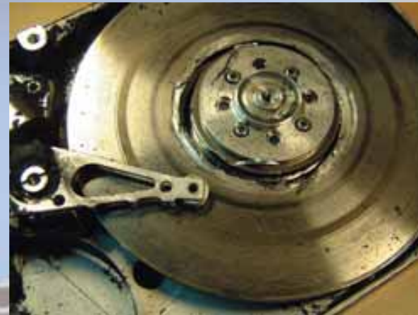
Поврежденная поверхность магнитного диска
