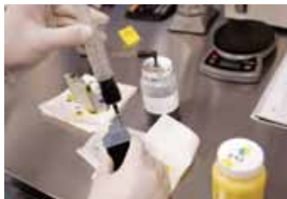
А так заправляют картриджи вручную
