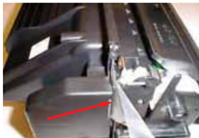
Разрушенный вытяжной ярлычок
