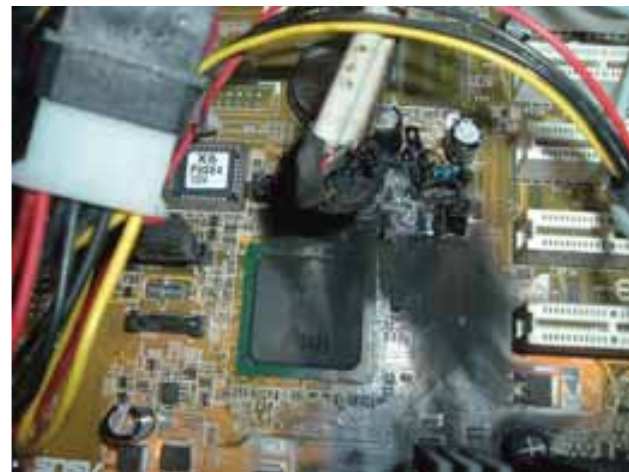
Результат неудачного "разгона" процессора
