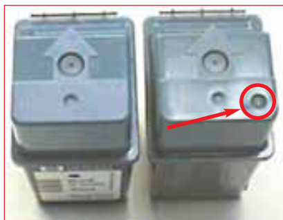
Отверстие после повторной заправки
