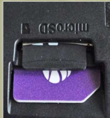
Такое расположение слотов для SIM-карты и microSD очень удобно и позволяет осуществлять их «горячую» замену
