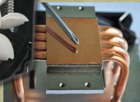
«Подшва» кулера отполирована до зеркального блеска
