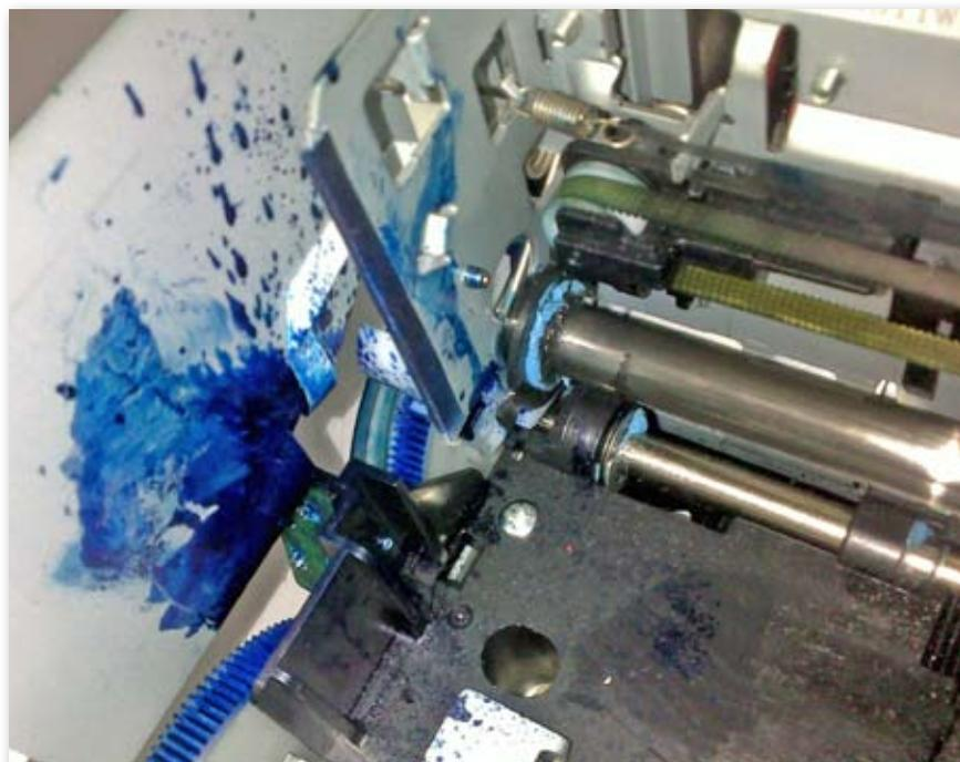
Неоригинальные чернила проникают в механизм принтера, что приводит к выходу устройства из строя
