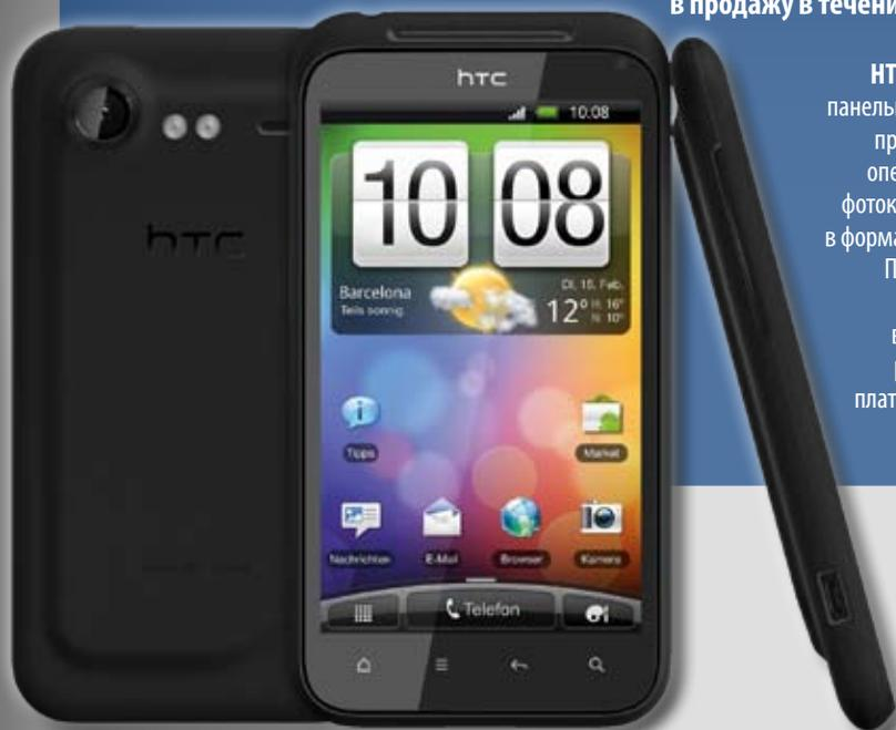
HTC Incredible S отличается необычным дизайном с рельефной задней панелью и наличием 4" экрана с разрешением 480x800 пикселей. В качестве процессора используется Qualcomm MSM8255 с частотой 1 GHz, а объем оперативной памяти составляет 768 Mb. Аппарат оснащен тыловой 8 Мр фотокамерой с двойной светодиодной вспышкой и функцией записи видео в формате HD 720p, а также фронтальной 1,3 Мр камерой для видеозвонков.
