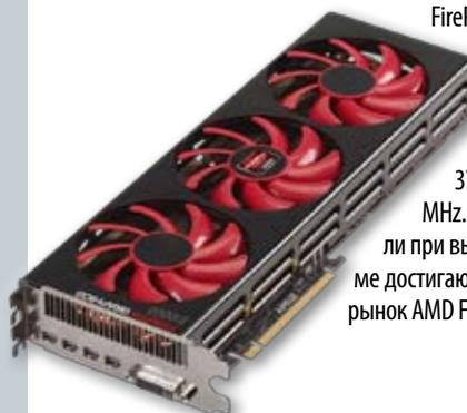
FirePro S10000 имеет поддержку шины PCI Express 3.0 x16, выполнена на текстолите черного цвета, имеет 6144 Мб видеопамати стандарта GDDR5 с 384-битным интерфейсом и два 8-pin разъема питания. Показатель TDP этой видеокарты равен 375 Вт, а частота работы ядер GPU составляет 825 MHz.
