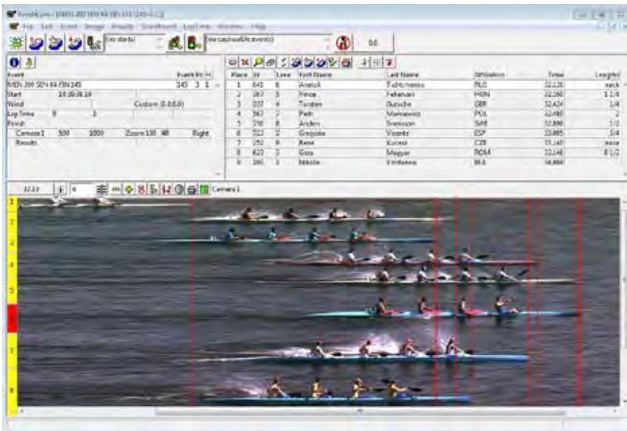
одно непрерывное изображение финишной линии на протяжении времени активного захвата. Оператор или судья фотофиниша расшифровывают полученное изображение, определяя порядок прихода и/или время участников.
