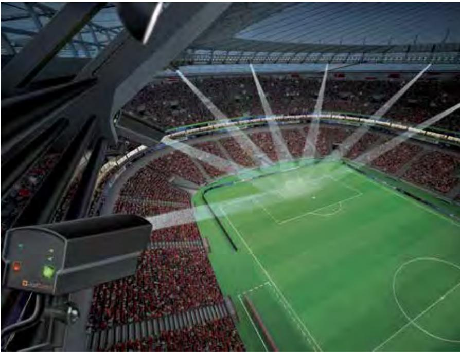
ние со всех камер, компонует углы и по принципу триангуляции разбивает на треугольники точные движения мяча. На основе собранной информации компьютер соединяет их в одну единую 3D-картину. Именно таким образом судьи получают точную до миллиметров информацию о положении мяча. Так что вы получили и ответ на вопрос, как во время теннисного поединка при трансляции воспроизводится точное положение мяча после удара.
